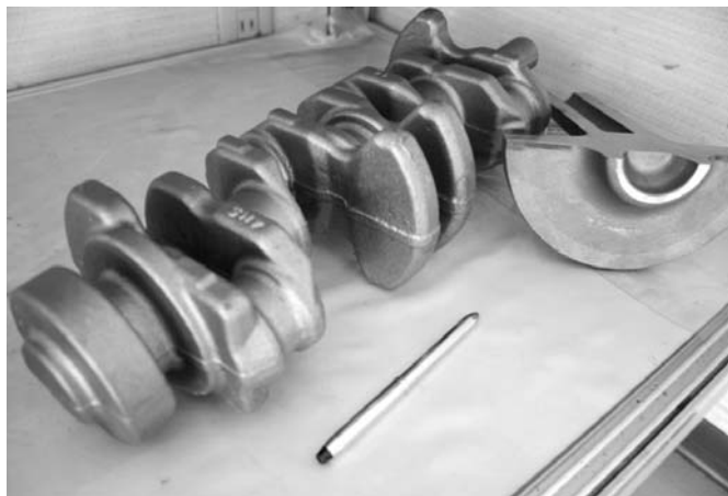
イチタンが手がけるクランクシャフト。部品会社は競争力強化に動きだしている
