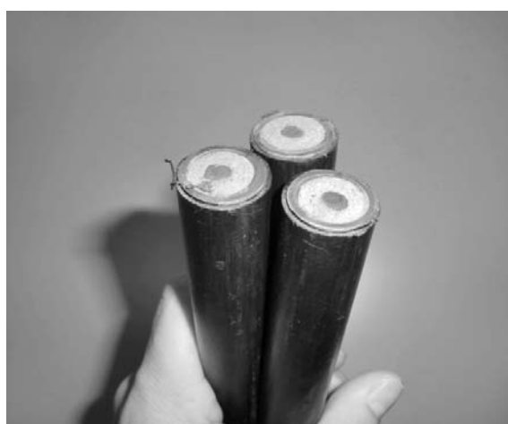
異素材混合物の一つである同軸ケーブル(右)と分離・処理された樹脂とアルミニウムと銅(左、ともにエムダイヤ提供)
