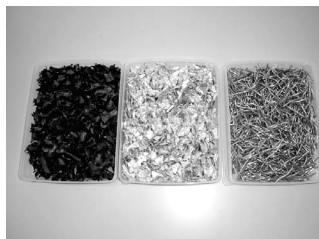
異素材混合物の一つである同軸ケーブル(右)と分離・処理された樹脂とアルミニウムと銅(左、ともにエムダイヤ提供)
