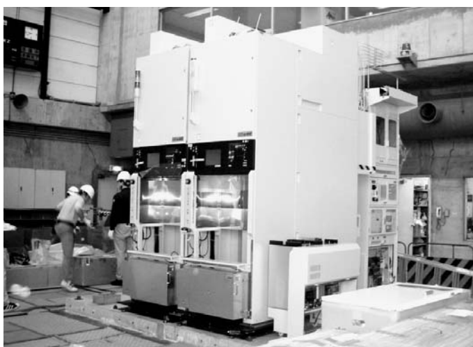
免震台を設置して振動実験中の縦型炉
