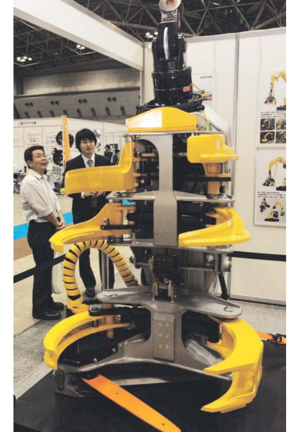
住友建機・住友重機械工業・住友林業は、一般には目にすることができない林業用のプロセッサー(造機)を披露する。プロセッサーは伐採した樹木の枝払い切断をする機械。
