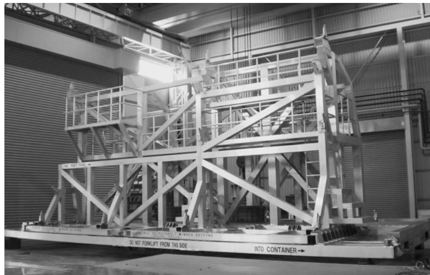
機体を分解して輸送するのに使う「シッピングフィクスチャ」、運ぶ際に機体を傷つけないように細部の製作が重要
