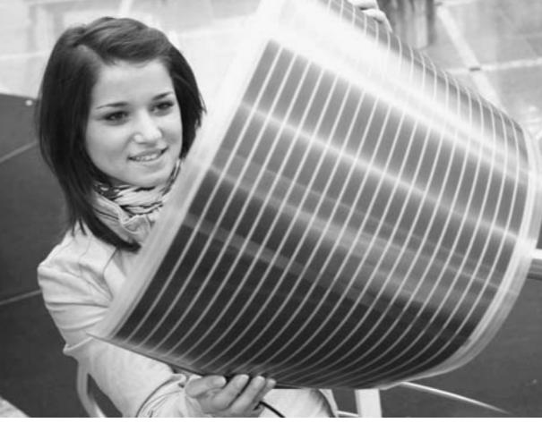
メルクは折り曲げ可能な有機薄膜太陽電池用の半導体材料を開発
