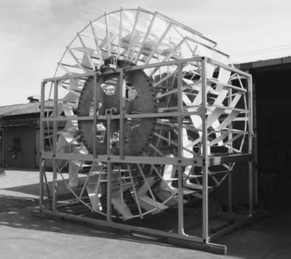
新開発の増速機構は円盤に等間隔に配置したローラーがスクローを回転駆動させる
