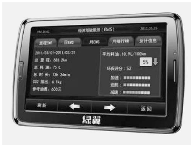
実証実験で使う車載端末には省エネ運転に向けて燃費や加減速の度合いなどデータを表示する(NTTデータ)
