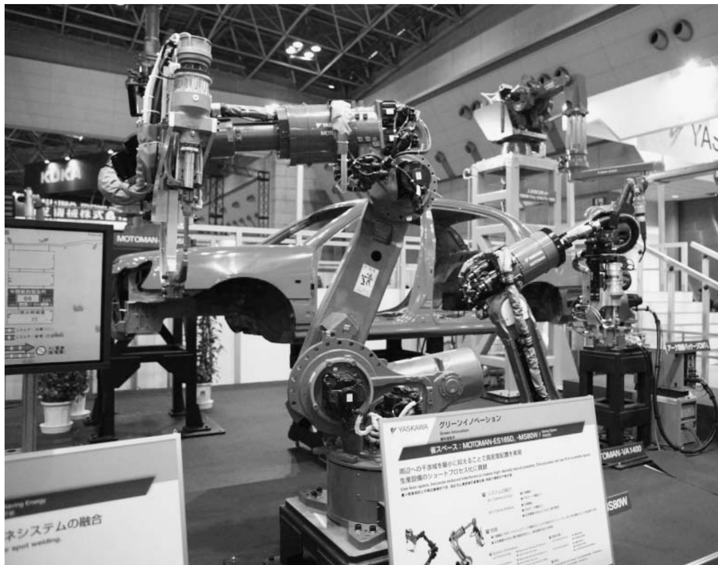
安川電機のスポット溶接ロボット。鋼板同士を接合し、自動車ボディをつくる
