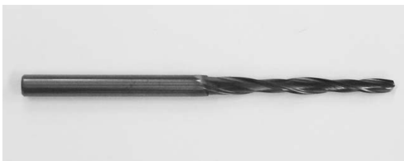
福井県工業技術センターのオリジナルの設計でつくられ、加工の難しいCFRPへの穴あけ作業を効率化するハイブリッドドリル
