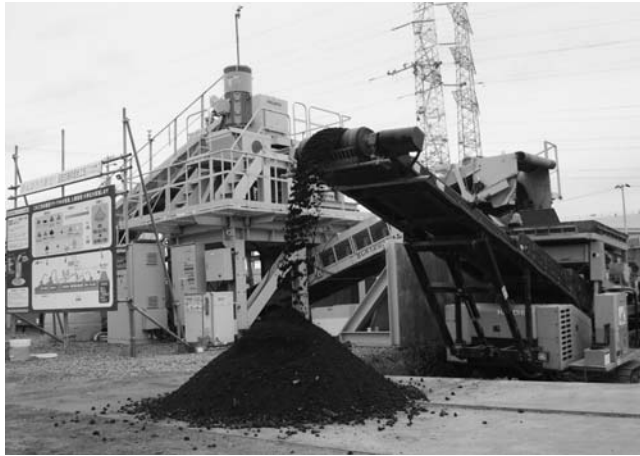
新日鉄などの技術の連携でヘッドロを改質処理した土（11年9月に実施した仙台市宮城野区での実証試験）
