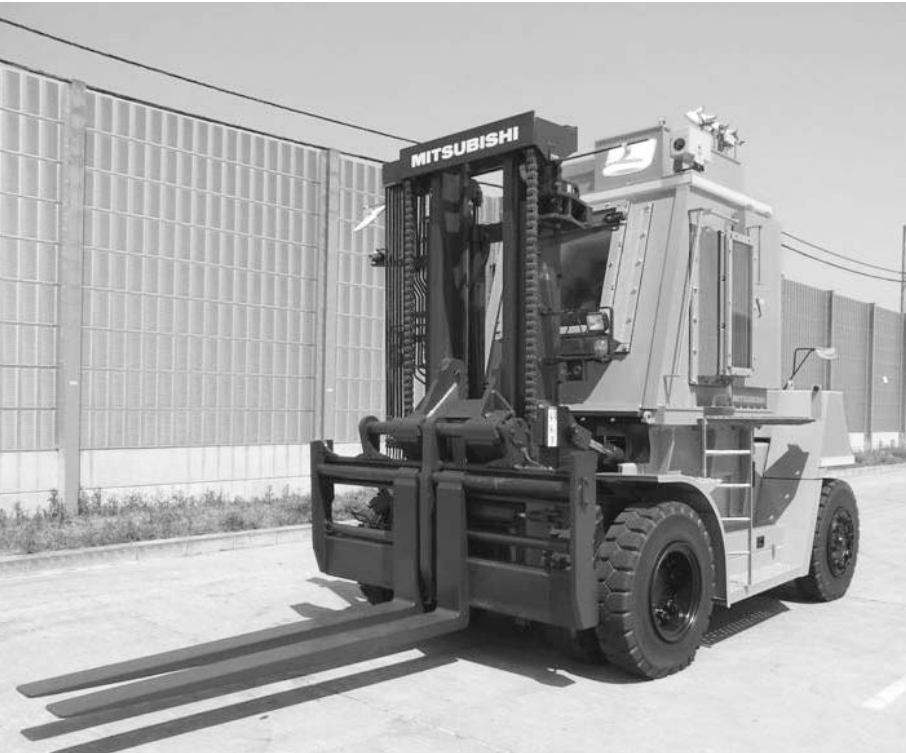
三菱重工の放射線を遮断するキャビンを搭載した大型特殊フォークリフト
