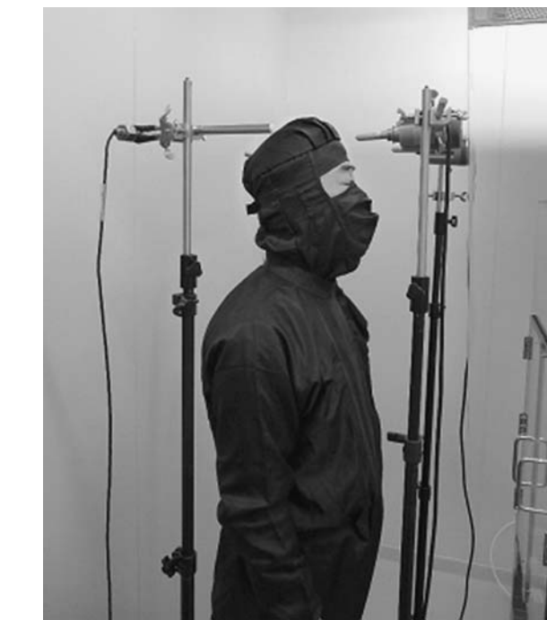
新日本空調によるドライルームの人体からの発生水分計測
