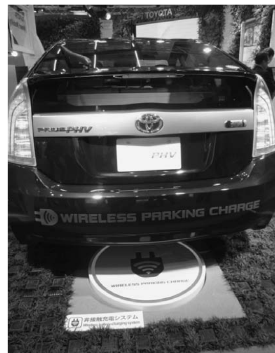
トヨタ自動車「スマート・モビリティ・シティー2011」に出展した非接触充電システム
