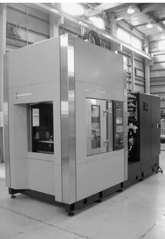
複数のノズルを用途に応じて自動交換する「KNC-01」
