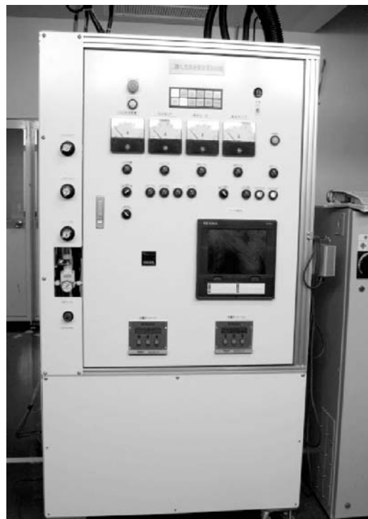
開発を進めている超臨界CO2塗装装置
