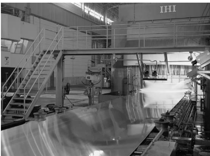
熱間圧延の様子 (写真は2点とも古河スカイ提供)
