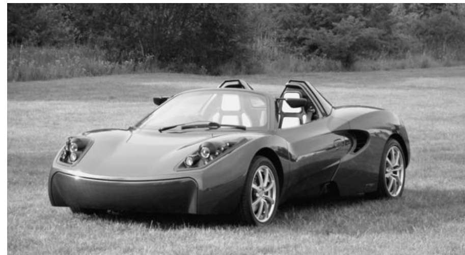
CFRPを用いて東レが試作したEV「TEEWAVE AR1」
