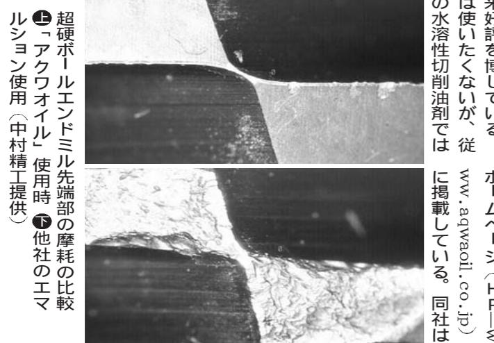
超硬ボールエンドミル先端部の摩耗率の比較
