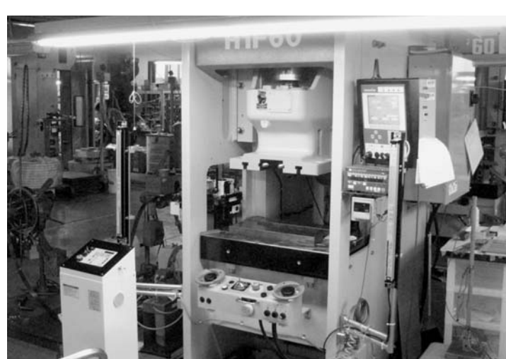
石関プレジジョンが導入した60トナーボプレス機
