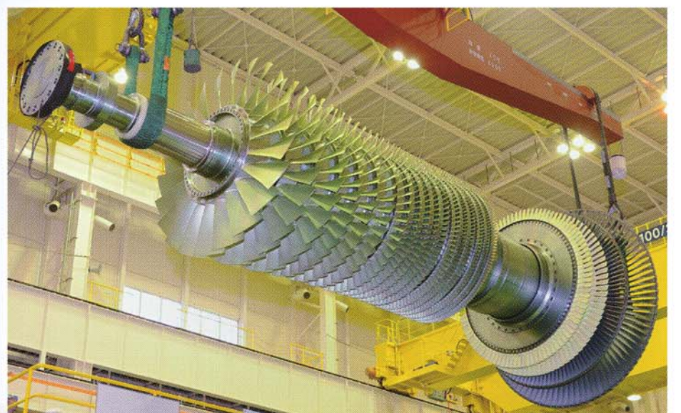
写真 三菱重工 M701F4形ガスタービン
