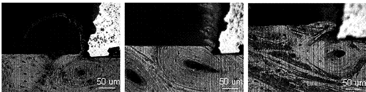
図7 骨切除挙動(工具=ダイヤモンドバイト、すくい角10度、試料=牛大腿骨)
