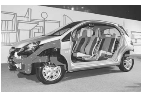
印プーシャン鋼板を「プリオ」に採用(カットモデル)
