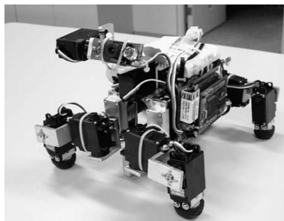
震災時の被災者救援に役立つよう開発された小型レスキューロボット
