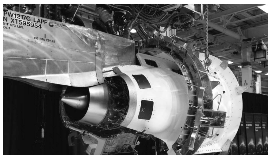
米プラット・アンド・ホイットニーが製造したMRJ用エンジン
