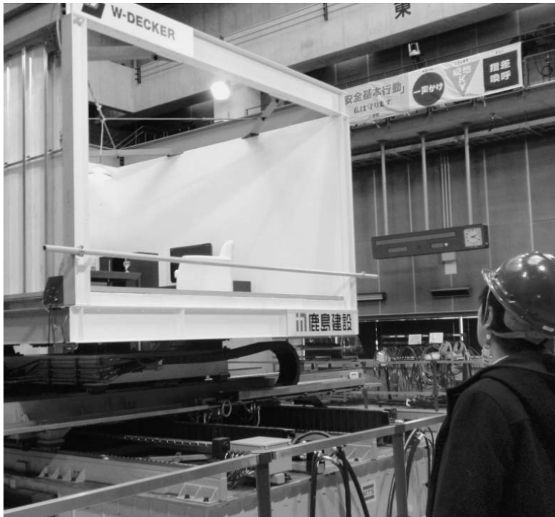
鹿島が技術研究所に導入した、最新鋭の3次元振動台「ダブルデッカー」
