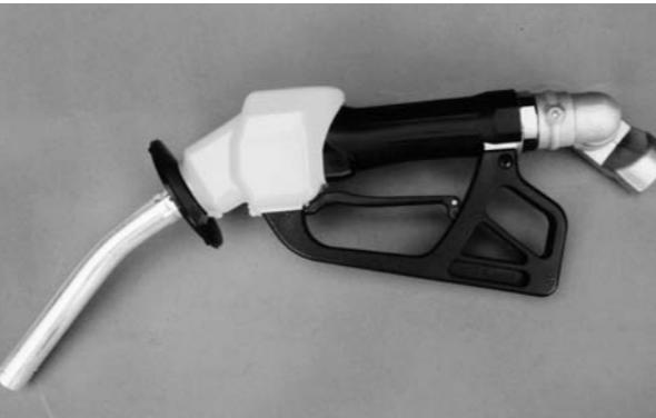
自動閉弁機構を備えており、液面が給油ノズルの先端に到達した時点で自動的に給油を停止する。この自動閉弁機構を作動させるために負圧発生機構がある。
