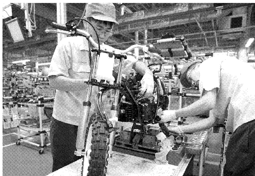
セル生産方式の導入で生産効率化(ヤマハ発動機本社工場)
