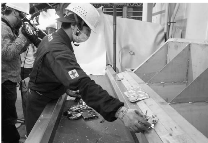
HDDからレアアース磁石を分離・回収するための選別コンベヤー(日立製作所)
