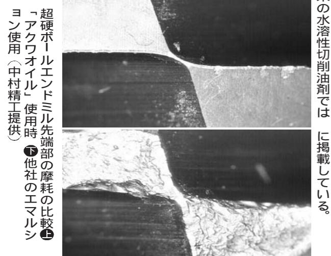
超硬ホールドミル先端部の摩耗の比較上
